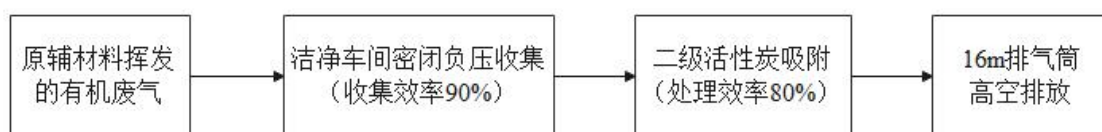
图 12 项目有机废气收集处理工艺示意图
